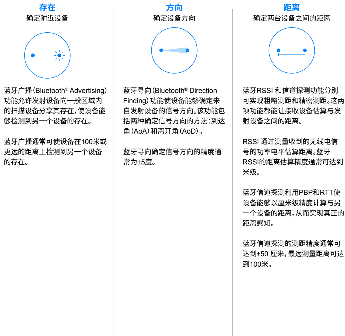
图3 蓝牙定位功能 (资料来源: 蓝牙技术联盟)
